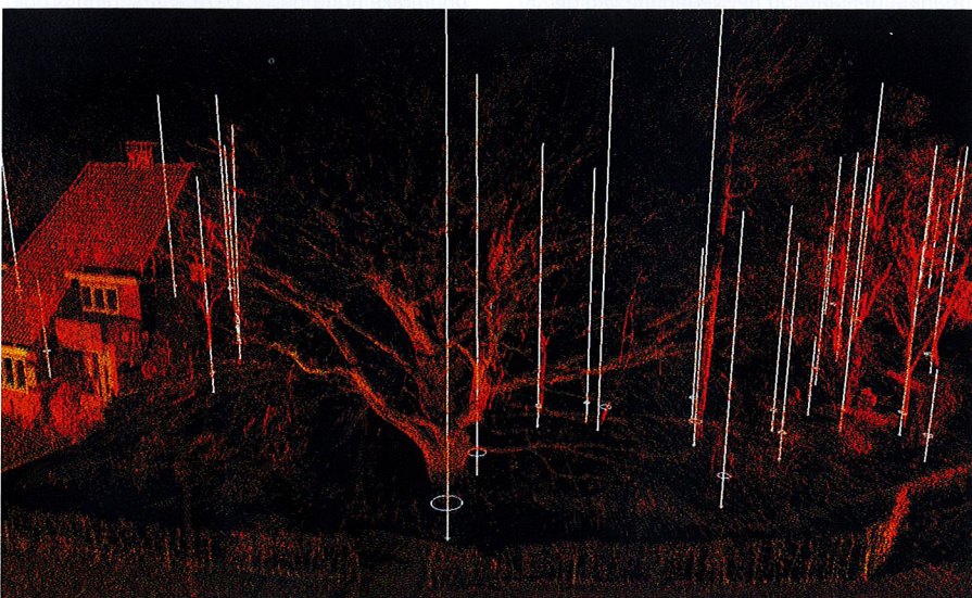
Met behulp van patroonherkenning worden bomen geïdentificeerd in de puntenwolk.
